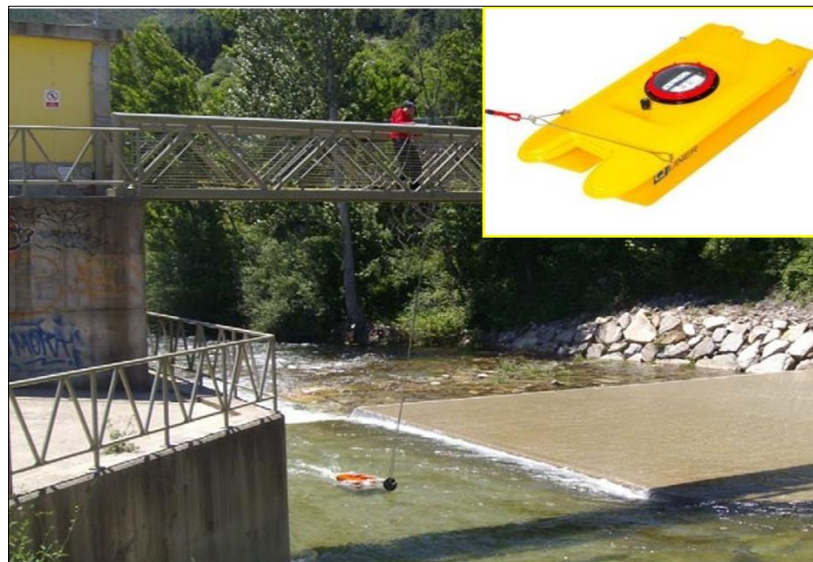
Figura 11. Perfilador acústico doppler empleado en el SAIH para la realización de aforos. Fuente: CHMS.
