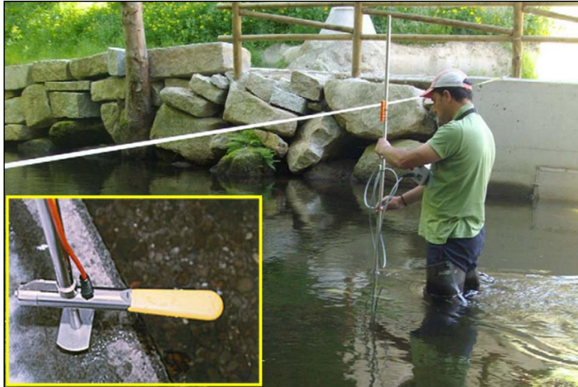
Figura 10. Medidor electromagnético empleado en el SAIH para la realización de aforos. Fuente: CHMS.
