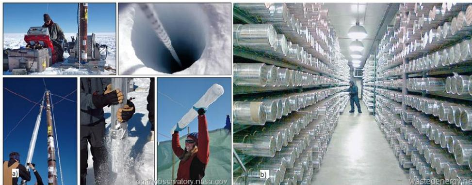
**Figura 1.5** La figura a) muestra como extraen un núcleo de hielo y la figura b) muestra la forma de almacenar los testigo de hielo una vez que se han extraído (<http://triplenlace.com>).
