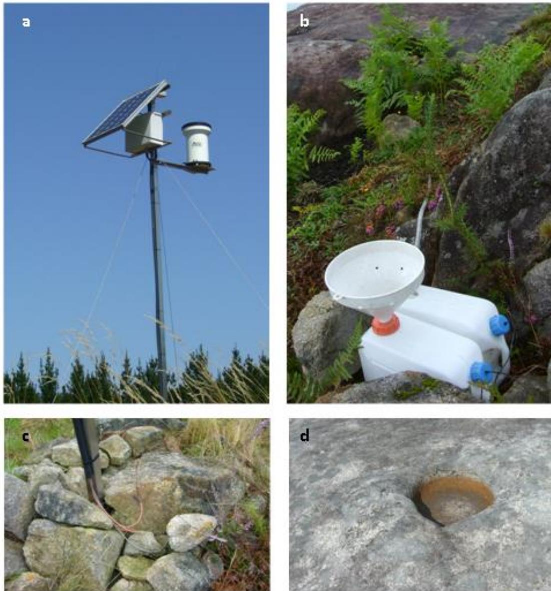
Fig. 1. (a): Dataloger y pluviómetro de balancín en la estación de Ventaniñas; (b): colectores de recogida de la deposición total y la escorrentía; (c): sensores para medir la temperatura superficial de la roca; (d): cazoleta natural (pía) en el petroglifo de Forneiriña con el fondo revestido de oxihidróxidos de Fe. Fotografías de Beatriz Prieto y Benita Silva.
