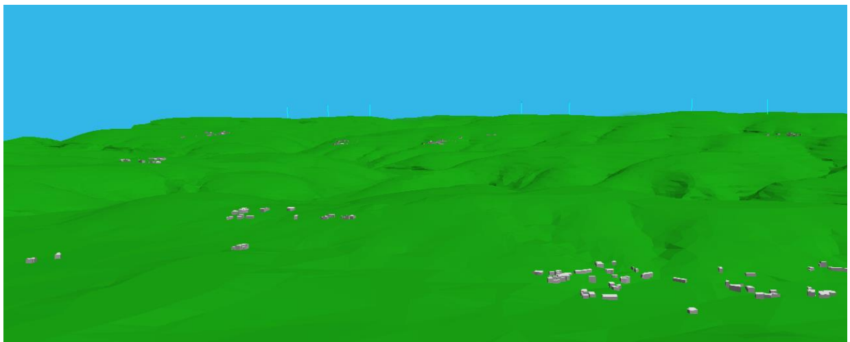
Figura 5. Modelo 3D del Parque Eólico modelado en CadnaA
