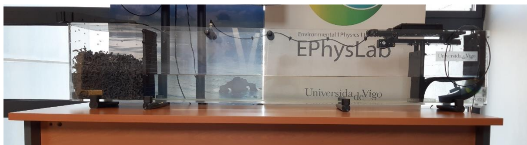
Figura 4.1 – Imagen del canal de olas nanoCIEM en las instalaciones del grupo EPhysLab.
