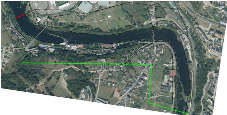
Fig. 6. Situación de la condición de entrada (línea roja) y condición de salida (línea verde) en la zona de estudio.
