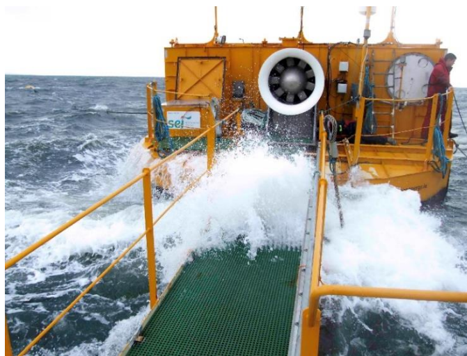
Figura 2-8: Dispositivo OE Buoy de la compañía Ocean Energy.
