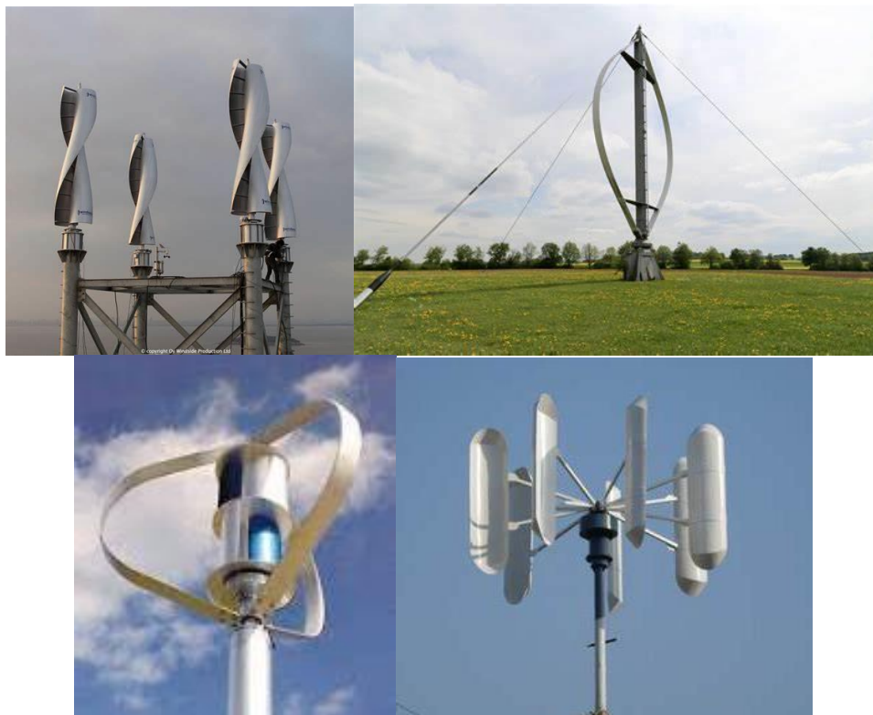
Figura 2. Aerogeneradores de eixo vertical. De esquerda a dereita e de arriba a abaixo, Savonius, Darrieus, Turbina mixta e Giromill.
