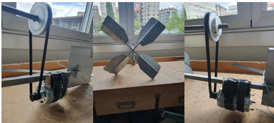
Figura 5. Partes do aeroxerador a escala construído. De esquerda a dereita: as aspas, a polea conectada no eixo superior con correa de transmisión e o motor Husillo / Spindle 775-80W con rodamentos de bolas.
