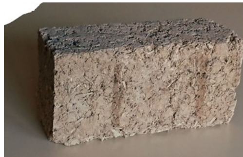
Figura 3. Bloque de Cannabric (BTC) empregado na construción das paredes.
